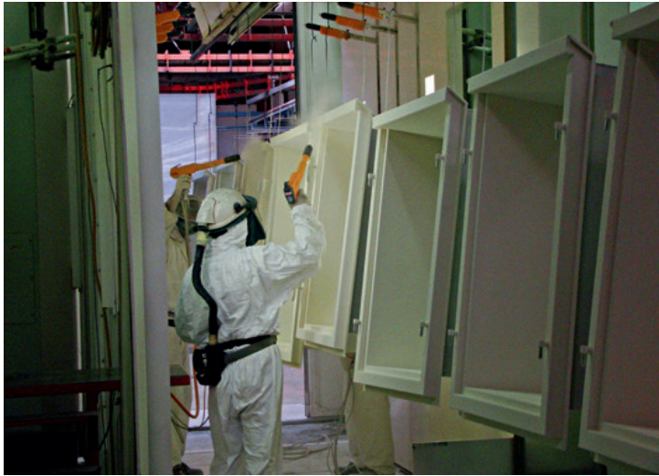
Ein Schwerpunkt der Jürg Hofstetter AG ist das Pulverlackieren stark beanspruchter Teile für den Außeneinsatz. Die Vorbehandlung muss auch die Haftfähigkeit des Pulvers auf dem Objekt sicherstellen. Quelle (zwei Bilder): Jürg Hofstetter
