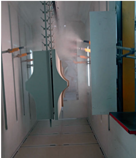
Die Anlage bei Jürg Hofstetter ist taktgesteuert und weist eine sehr konstante Gehängebelegung auf. Darum wird auch die Chemie taktgesteuert zugeführt.
